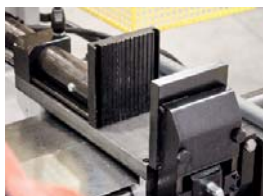
Imadło hydrauliczne o dużej wytrzymałości
