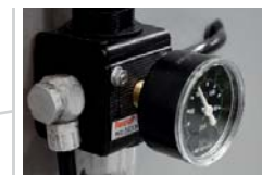
Wskaźnik i regulacja ciśnienia wejściowego z filtrem
