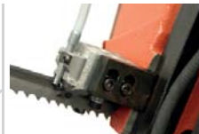
Prowadnica precyzyjna z twardego stopu
