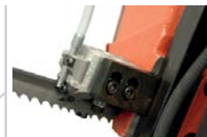
Prowadnica precyzyjna z twardego stopu
