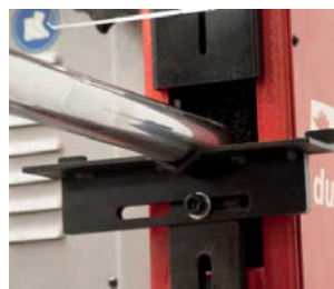
Regulowana pokrywa części wejścia obrabianej części, umożliwiająca maksymalną zmienność roboczą
