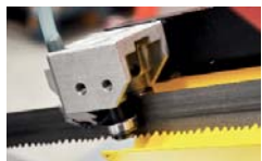
Precyzyjna prowadnica taśmy piły z twardego metalu
