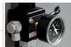
Wskaźnik i regulacja ciśnienia wejściowego z filtrem
