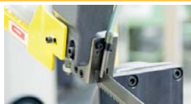
Precyzyjna prowadnica taśmy piły z twardego metalu
