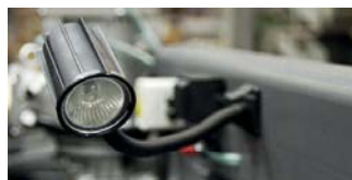
Lampa halogenowa dla przestrzeni roboczych
