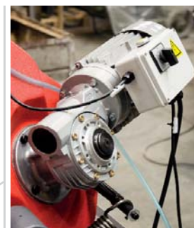
Silnik z dwiema prędkościami i przekładnią ślimakową
