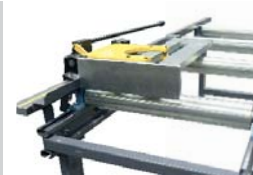
Ręczny ogranicznik materiału XA. Długość suwaka i zamocowanie ustawiane są ręcznie. Długość jest odczytana z taśmy pomiarowej z dołączonym szkłem powiększającym. Ogranicznik może być ręcznie nachylny do góry, aby umożliwić gładkie przejście materiału.
