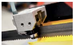
Precyzyjna prowadnica taśmy piły z twardego metalu
