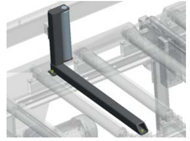
XVR - NC – Pionowy przenośnik rolkowy do ogranicznika materiału
