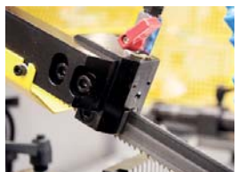
Prowadnica precyzyjna z twardego stopu
