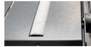
Solidne rolki plastikowe zapewniają ciągły ruch materiału i chronią go przed uszkodzeniami
