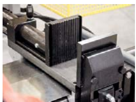
Imadło hydrauliczne o dużej wytrzymałości
