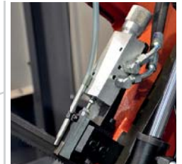
Automatyczna regulacja docisku opuszczania ramienia
