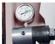
Wskaźnik napięcia taśmy pily
