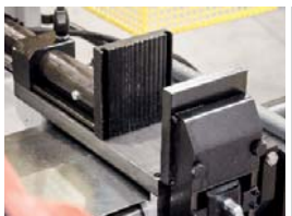
Imadło hydrauliczne o dużej wytrzymałości
