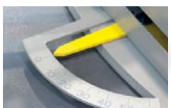
Dobrze wykonany kątownik, ergonomicznie umieszczony z przodu urządzenia
