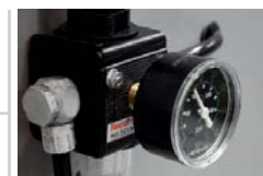
Wskaźnik i regulacja ciśnienia wejściowego z filtrem
