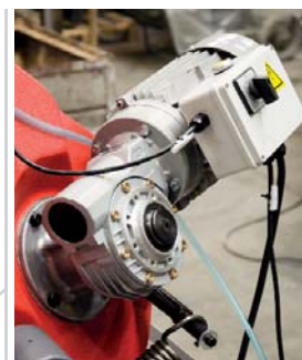
Silnik z dwiema prędkościami i przekładnią ślimakową
