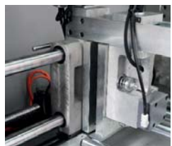
Wytrzymałe imadło podające do precyzyjnego podawania materiału
