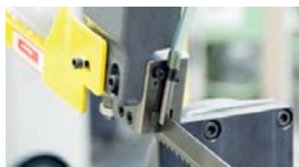
Precyzyjna prowadnica taśmy piły z twardego metalu
