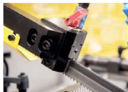
Prowadnica precyzyjna z twardego stopu
