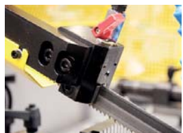
Prowadnica precyzyjna z twardego stopu
