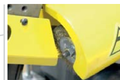
Szczotka do czyszczenia taśmy przecinarki
