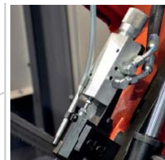
Automatyczna regulacja docisku opuszczania ramienia
