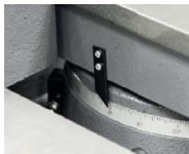
Podziałka kątowa obrotu ramienia
