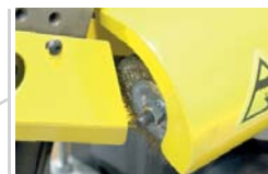
Szczotka do czyszczenia taśmy przecinarki
