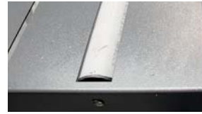
Solidne rolki plastikowe zapewniają ciągły ruch materiału i chronią go przed uszkodzeniami
