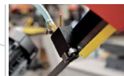
Precyzyjna prowadnica taśmy piły z twardego metalu
