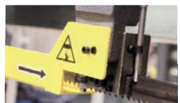
Precyzyjna prowadnica z twardego stopu
