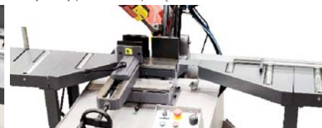
Prawy i lewy przenośnik - podłączenie
