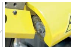
Szczotka do czyszczenia taśmy przecinarki
