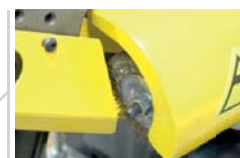
Szczotka do czyszczenia taśmy przecinarki
