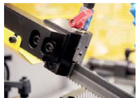
Prowadnica precyzyjna z twardego stopu
