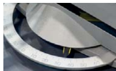
Dobrze wykonany kątownik, ergonomicznie umieszczony z przodu urządzenia
